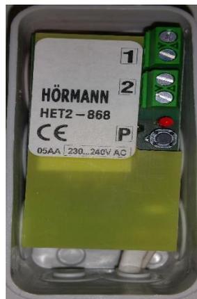
1. Sur le récepteur, appuyez sur le bouton de programmation P : une fois pour le canal 1, deux fois pour le canal 2. La diode du récepteur clignote : une fois pour le canal 1, deux fois consécutives pour le canal 2.
