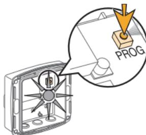
1. Sur le récepteur, appuyez sur le bouton PROG. La diode du récepteur s'allume.
