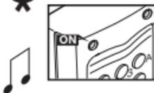
**3c** Composer sur le clavier le nouveau code numérique à mémoriser (maxi. 6 chiffres) et confirmer par une pression sur "\*" (par exemple: 112233 \*).
